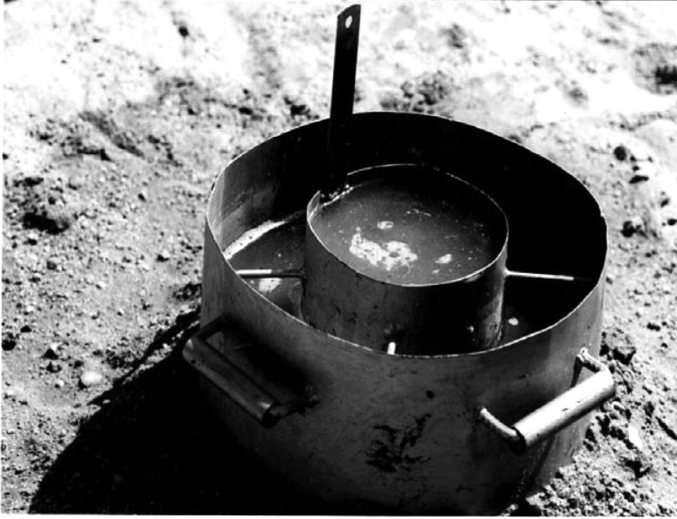
الشكل (٩) - قياس التسرب الرأسى للمياه في التربة (الأسطوانة المزدوجة Double Ring)
