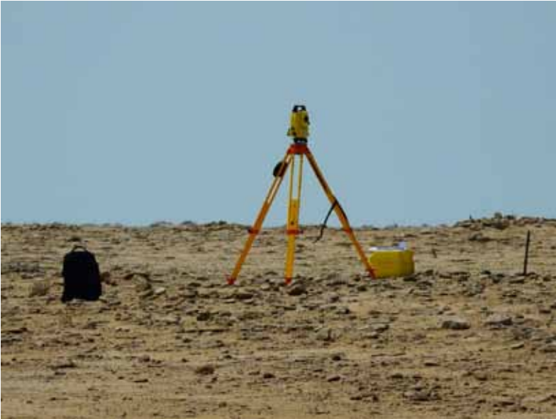
لوحة ٦: جهاز التوتل ستیشن المستخدم في إدارة الآثار والمتاحف، تصوير حامد المطيري.
