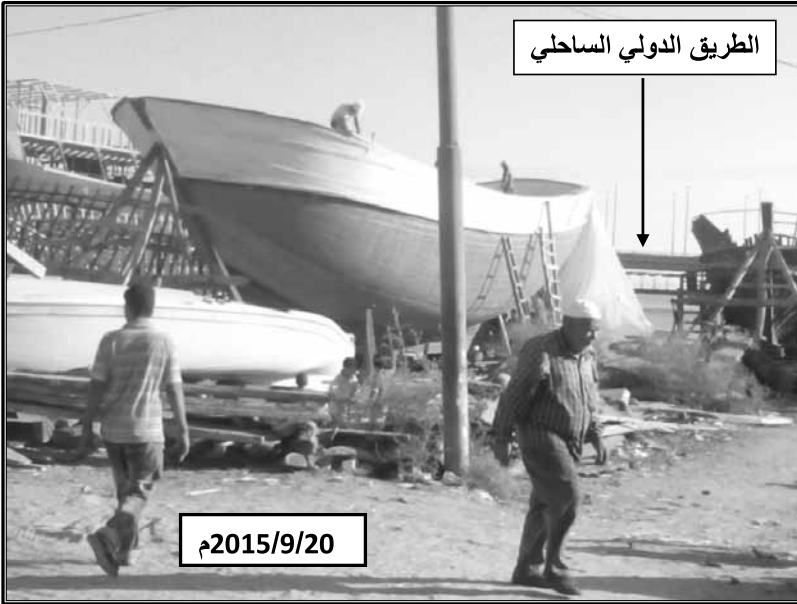
صورة (٢) : المراحل الأخيرة من صناعة مركب صيد بمدينة البرج
